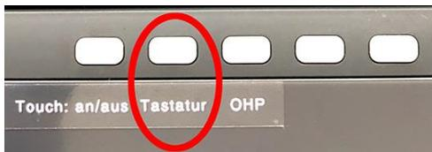
Für den Fall, dass Sie zum Tippen von Text eine **Tastatur** benötigen, können Sie diese über die mit der Beschriftung „**Tastatur**“ bezeichnete **Schnellauswahltaste** ein oder ausblenden.
