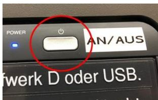
Um das Gerät verwenden zu können, schalten Sie das Gerät mit dem **Ein/Aus-Schalter am rechten oberen Rand** ein. Nach dem Einschalten zeigt das Gerät den Windows-Desktop und Sie können nun damit arbeiten.
