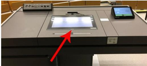
In der Mitte der Hörsaalpult-Tischfläche ist das **Wacom-Tablet** eingelassen. Es handelt sich hierbei um das Display eines **regulären** dahinter befindlichen **Windows-PCs**. Um Dateien auf diesem Rechner zu öffnen oder zu speichern sind **zwei USB-Anschlüsse** des Rechners (bezeichnet mit „Wacom“) in die Signalanschlussleiste, die sich auf dem Hörsaalpult hinten links befindet, integriert. Dort kann ein mitgebrachter **USB-Stick** angeschlossen werden.
